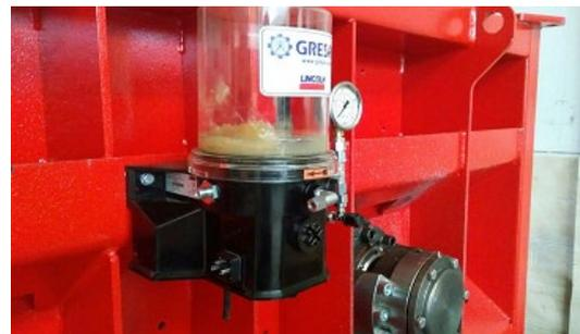
Специально разработанная подшипниковая группа Двухвальных Смесителей состоит из нескольких металлических и полиуретановых уплотнителей. Подшипники устанавливаются на внешних стенках смесителя в специальное гнездо, которое предотвращает просачивание смеси внутрь. Автоматическая система смазки постоянными импульсами подает в лабиринт из уплотнителей смазку, которая создает высокое давление внутри и предотвращает попадание смеси изнутри.
